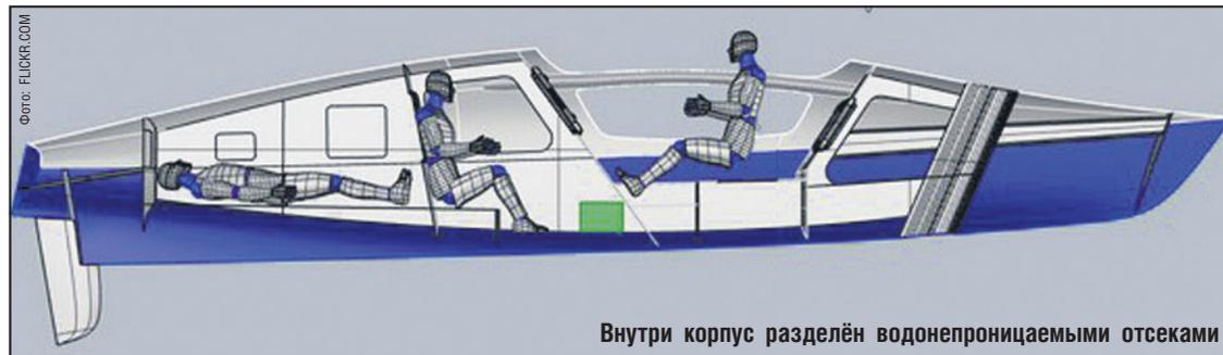
Внутри корпус разделён водонепроницаемыми отсеками
