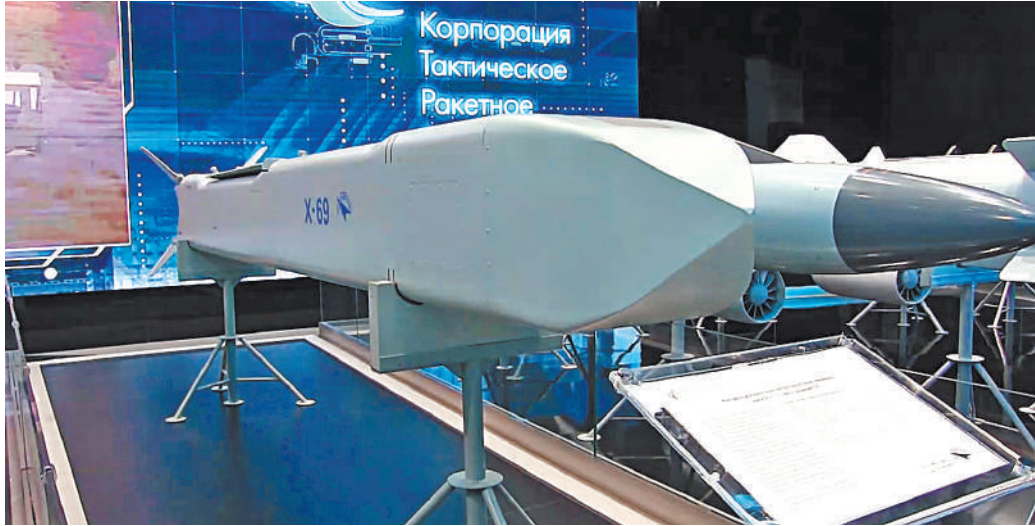
Ракета «воздух — земля» Х-69 изготовлена по технологии «стелс» и несет боевую часть весом около 400 кг.
