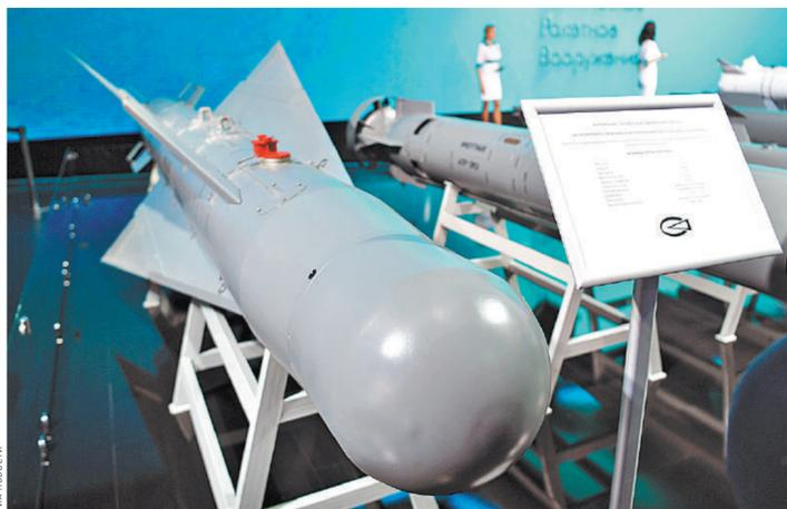
Наведение планирующей авиабомбы комбинированное — инерциальная система и спутниковая навигация.
