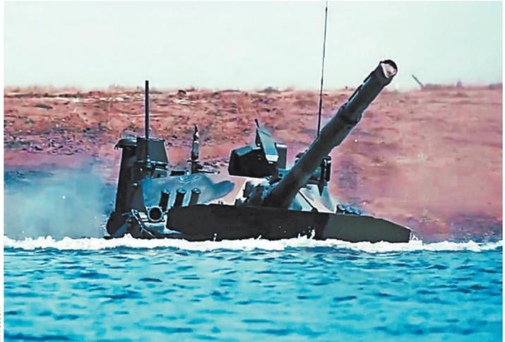
«Спрут-СДМ1» не только обладает высокой маневренностью на суше, но и уверенно держится на плаву даже при волнении в три балла.
