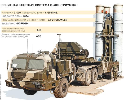
соте 56 километров. Серийные С-400 способны уничтожать воздушные объекты на расстоянии ло 400 км, вести одновременный обстрел до 36 целей и наводить на них до 72 ракет. Применение нескольких типов боеприпасов позволяет с помощью «четырехсоток» создавать эшелонированную систему ПВО. «Триумф» способен решать задачи противовоздушной и нестратегической противоракетной обороны. А используемые в зенитной ракетной системе средства автоматизации практически исключают ошибки, вызванные так назы-
