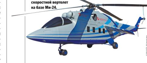
Скоростной вертолет нельзя строить по классической схеме с несущими и компенсирующими винтами. Неизбежно наступит момент, когда сила заваливания винтокрыла не удастся компенсировать никаким рулевым винтом.
